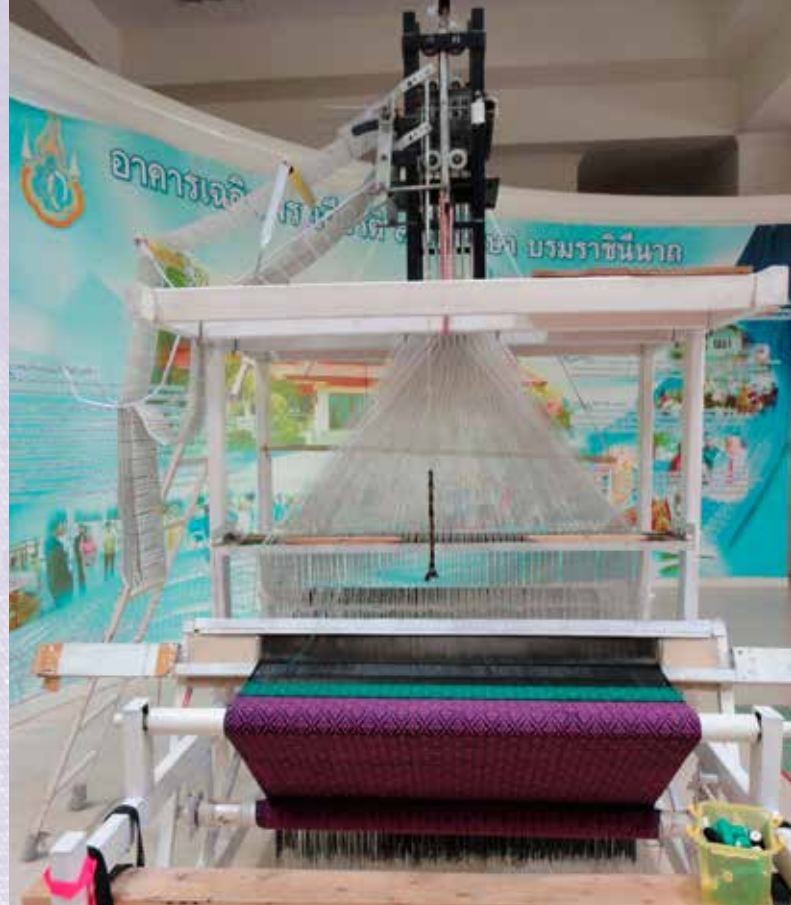
เครื่องทอผ้าเมื่อประกอบ และติดตั้งเครื่องแจ็กการ์ด
