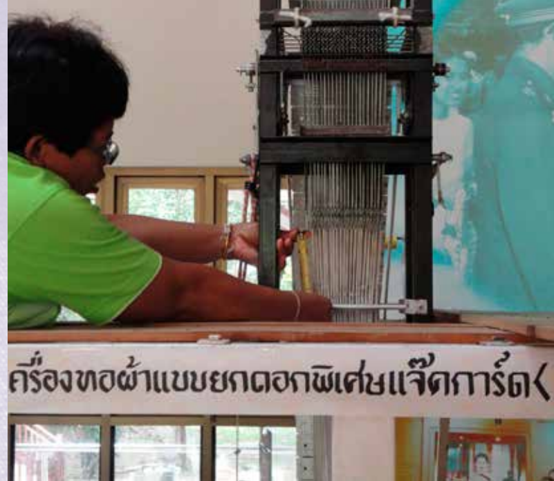
(ซ้าย) แสดงการประกอบการ์ดที่เจาะเพื่อประกอบเข้ากับเข็มยกตะกอก (ขวา) แสดงการตรวจสอบเข็มตะกอกที่ยังสายสำหรับการทอ
