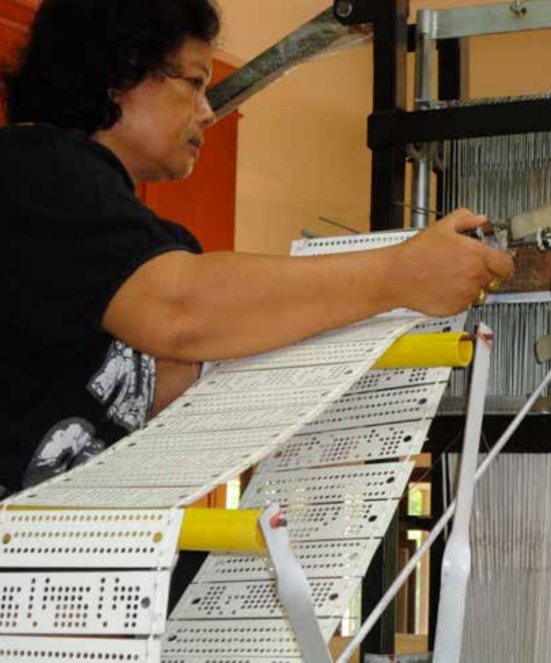
(ซ้าย) แสดงการประกอบการ์ดที่เจาะเพื่อประกอบเข้ากับเข็มยกตะกอก (ขวา) แสดงการตรวจสอบเข็มตะกอกที่ยังสายสำหรับการทอ
