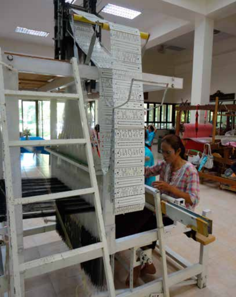
(ซ้าย) แสดงการยกตะกวดด้วยการ์ด (บัตรเจาะรู) (ขวา) แสดงการทอผ้าลายประจำยามด้วยเครื่องแจ๊คการ์ด
