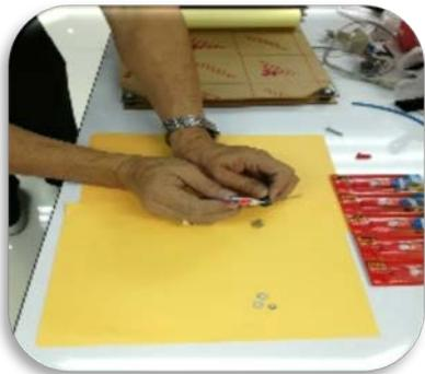
2.7 ติดการยึดสกรูกับสวิทช์เลือกย่างการใช้งานขนาดเล็ก พร้อมทั้งติดตั้งเข็มวัดค่าอ่าน
