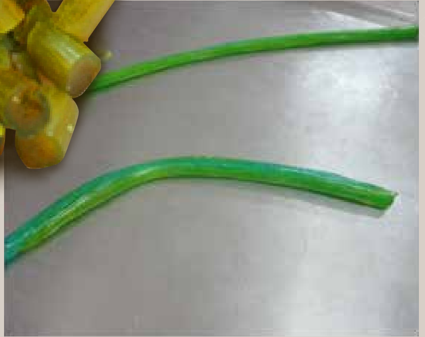
ลูกอมชนิดแข็งแบบม้วนถูกนวดเป็นเส้นก่อนการตัดแบ่งเป็นเม็ด
