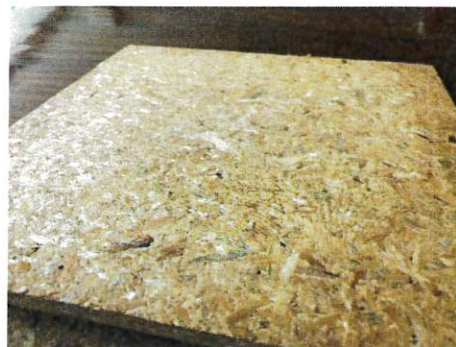
รูปที่ 2 แผ่นพาร์ติเคิลบอร์ดจากวัสดุเหลือทิ้ง ทางการเกษตร
